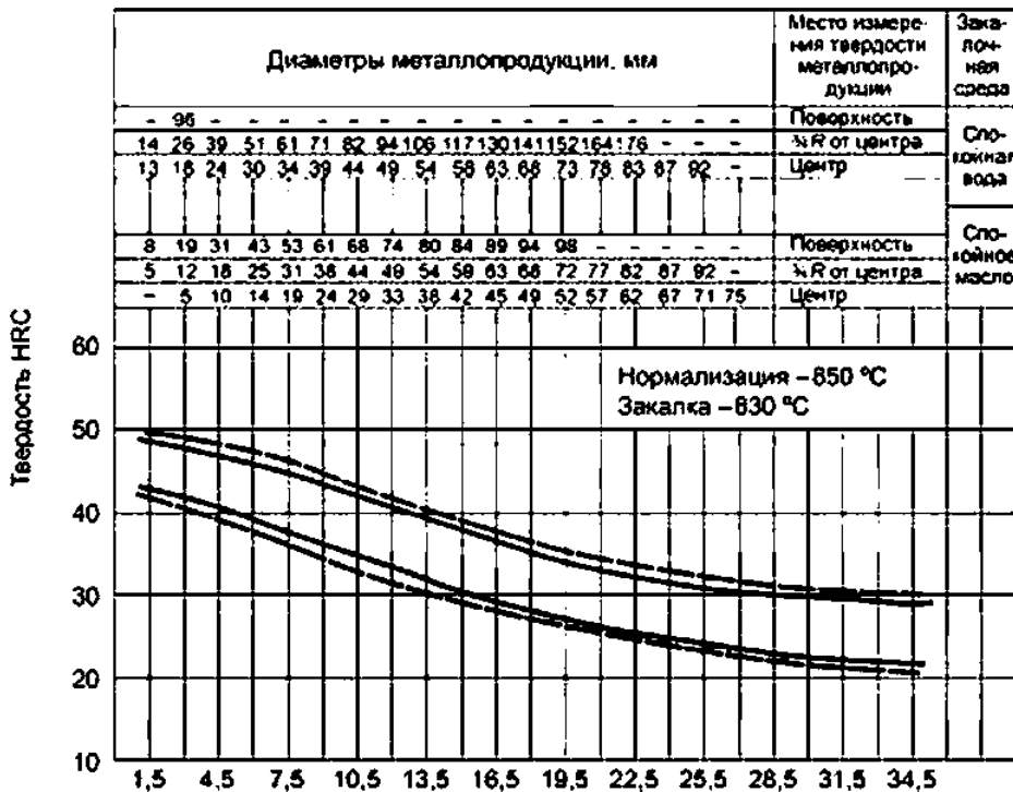
Рисунок А.15 — Сталь марки 12ХН3А
