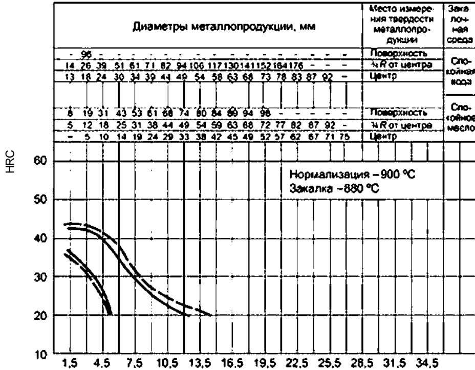
Рисунок А.1 — Сталь марки 15X
