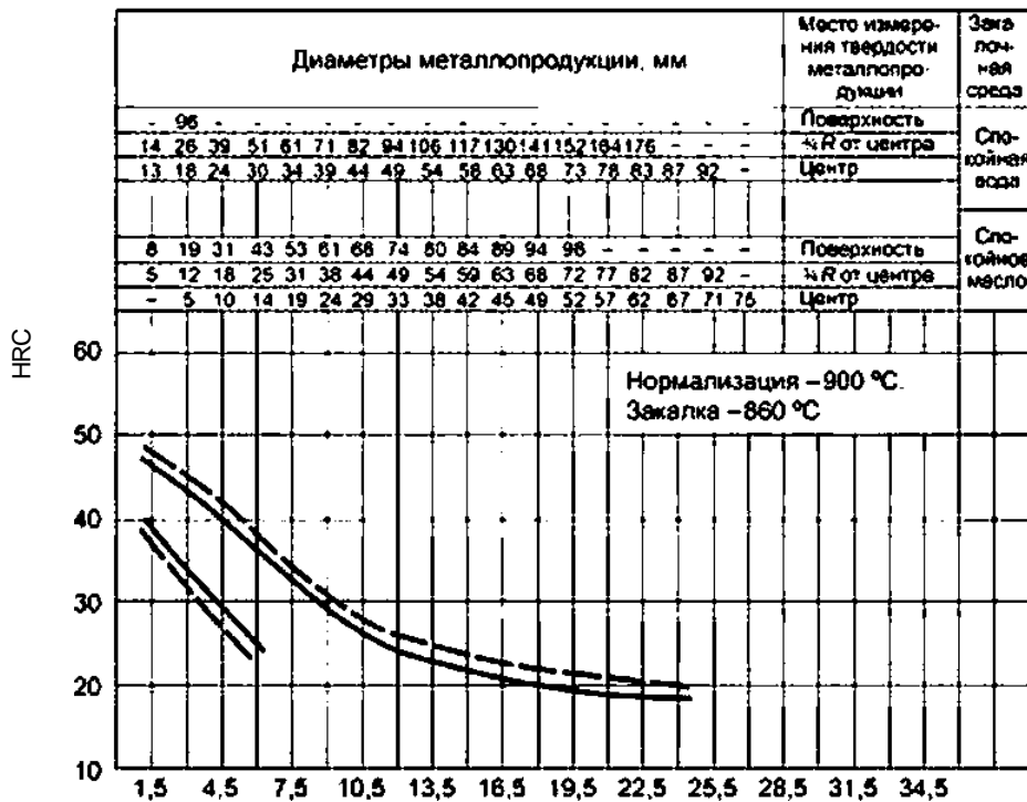
Рисунок А.1 — Сталь марки 15X
